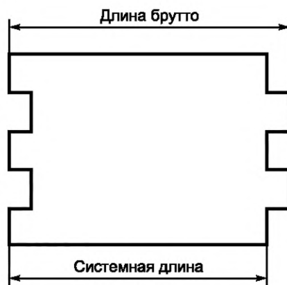
Рисунок А.1 — Размеры изделий с пазогребневым соединением
